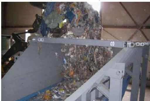
Накопичувальний стрічковий конвеєр (над підлогою)
