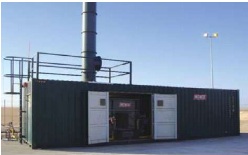
Рисунок д.11.3. Контейнерна сміттєспалювальна установка
